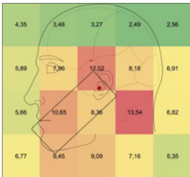
Рис. 1. Матрица распределения ППЭ ЭМИ от MT Philips x2301 в режиме набора номера, соотнесенная со схемой черепно-мозговой топографии головы человека
