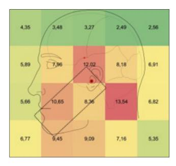
Рис. 1. Матрица распределения ППЭ ЭМИ от MT Philips x2301 в режиме набора номера, соотнесенная со схемой черепно-мозговой топографии головы человека Fig. 1. EMF intensity distribution matrix in dial mode for Philips x2301 combined with human brain topography scheme
